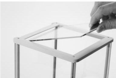
3) Install Top Door
